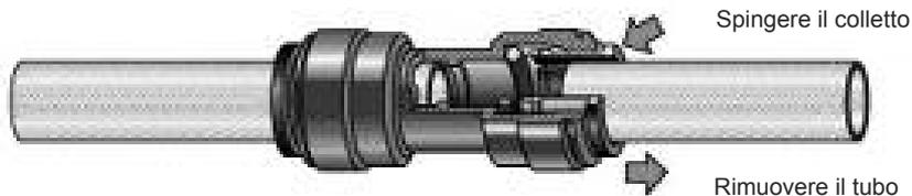
Spingere il tubo nel connettore del raccordo fino a quando non si ferma. Cercare di tirare fuori il tubo per controllarne la sicurezza. Se il tubo viene fuori, spingere tutto dentro di nuovo.
