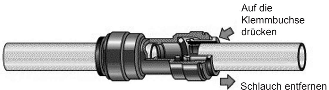
Schieben Sie den Schlauch soweit fest in die Muffenverbindung bis der Schlauch sich nicht mehr bewegt. Versuchen Sie den Schlauch herauszuziehen, um sich zu versichern, dass die Verbindung hält. Falls sich der Schlauch herausziehen lässt, schieben Sie ihn nochmals soweit wie möglich hinein.
