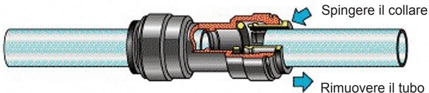
Spingere con decisione il tubo nel connettore di raccordo finché il tubo si arresta. Cercare di tirar fuori il tubo per verificarne l'inserimento sicuro. Se il tubo esce, spingere di nuovo fino in fondo.
