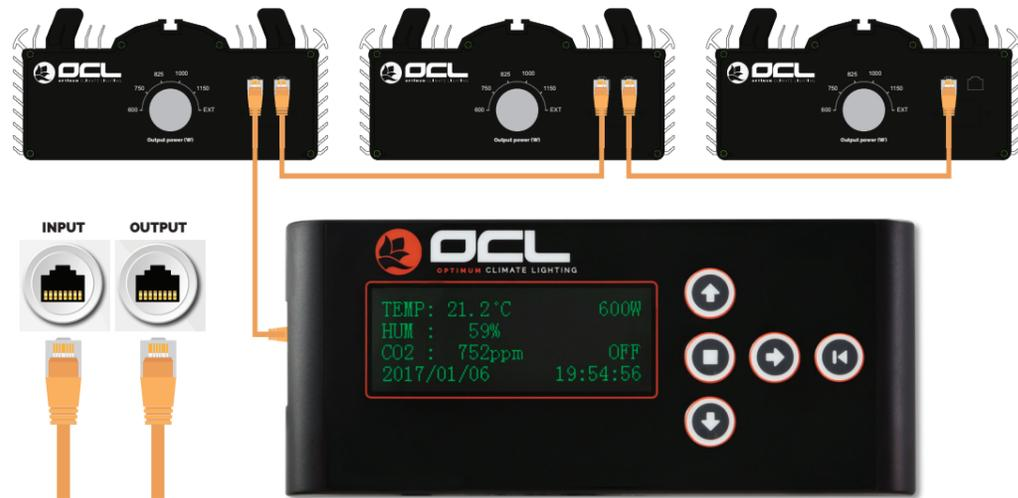
Die X-Serien von OCL verfügen über eine extrem starke und höhere PAR-Leistung als traditionelle Armaturen und benötigen daher einen Smart-Controller. Daher hat OCL die smarteste Beleuchtungssteuerung der Welt entwickelt, deren Bedienung dennoch denkbar einfach ist.
